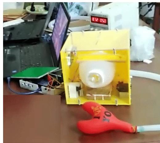
تم تصميمه الشكل الخارجي من ماده بريسيبيكس ارخص في التكلفه وتم تشكيلها بواسطه مكنه cnc lezar ومن ثم تجميعها لتصبح على الشكل النهائي ادناه
