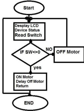
يتم في البدايه تشغيل الجهاز ومن ثم عرض حالة الجهاز على شاشه عرض ومن ثم قراده حالة المفاتيح التشغيل اذا تم ضغط اي واحد منها يعمل المотор بسرعه محدده لتحريك أنبوبيه ضخ الهواء وتتكرر العملية يمكنك الاطلاع وتنزيل الكود البرمجي عبر الرابط هنا
