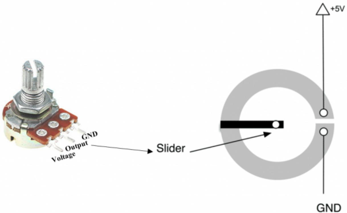
في المقاوم المتغير "pot" يوجد مسار يمثل المقاومة، في هذه الحالة مقاومه مقدارها 10 kΩ . كما يوجد سن متوسط يعتبر الموصل الفاصل يسمى "Slider" وظيفته هي تغيير مقدار المقاومة ما بين 0 وحتى 5V
