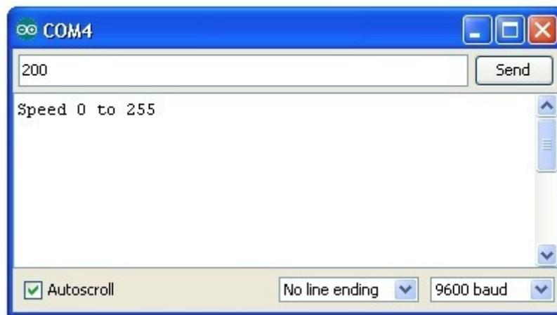
في دالة loop الأمر 'Serial.parseInt' يستخدم لقراءة الرقم المدخل عبر شاشة الاتصال التسلسلي Serial Monitor وتحويله لقيمة رقمية 'int'.
