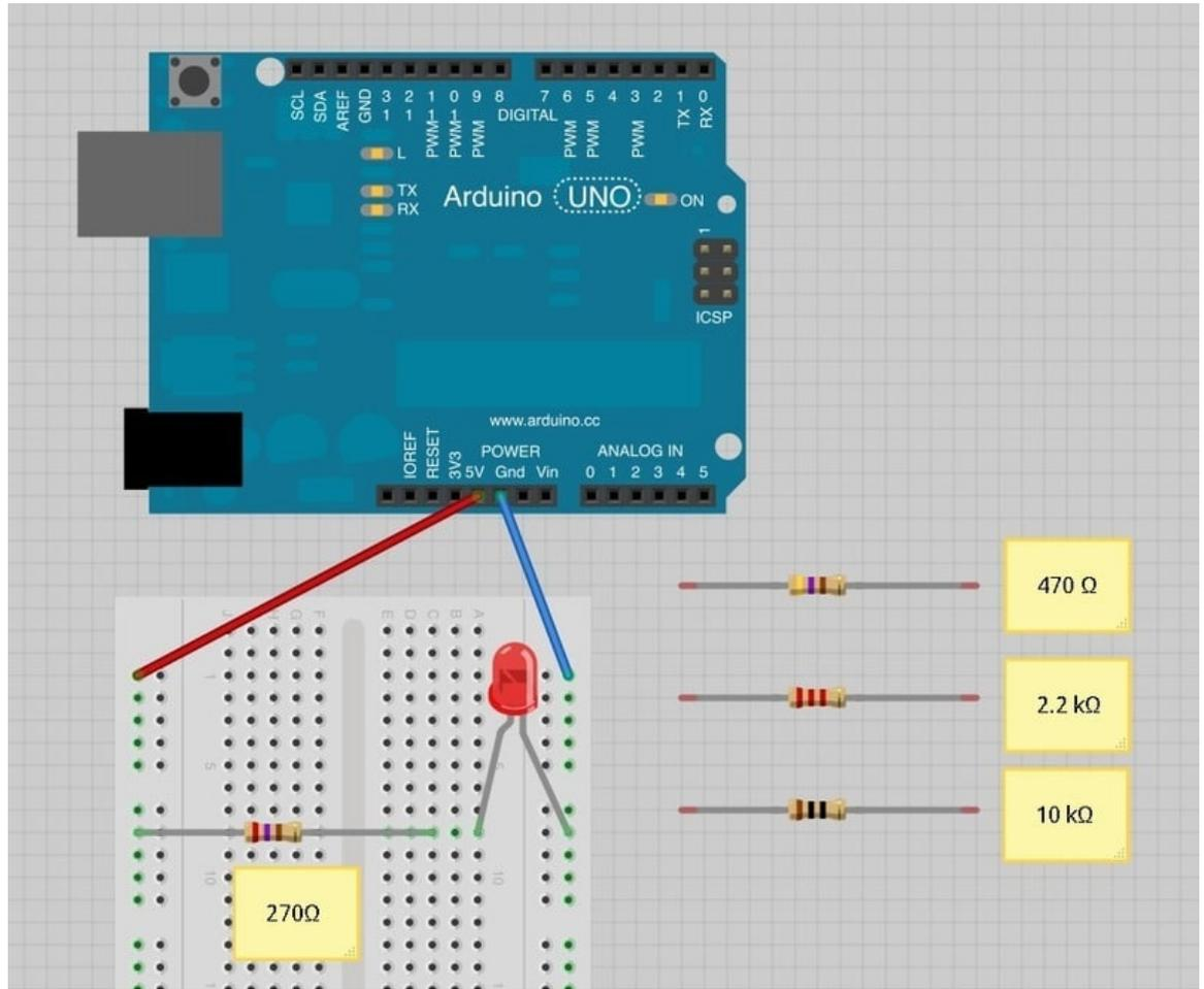
يمكن للأردوينو أن يمدك بطاقة مقدارها 5Volts التي ستوفر الطاقة الكافية لـ LED والمقاومة.
