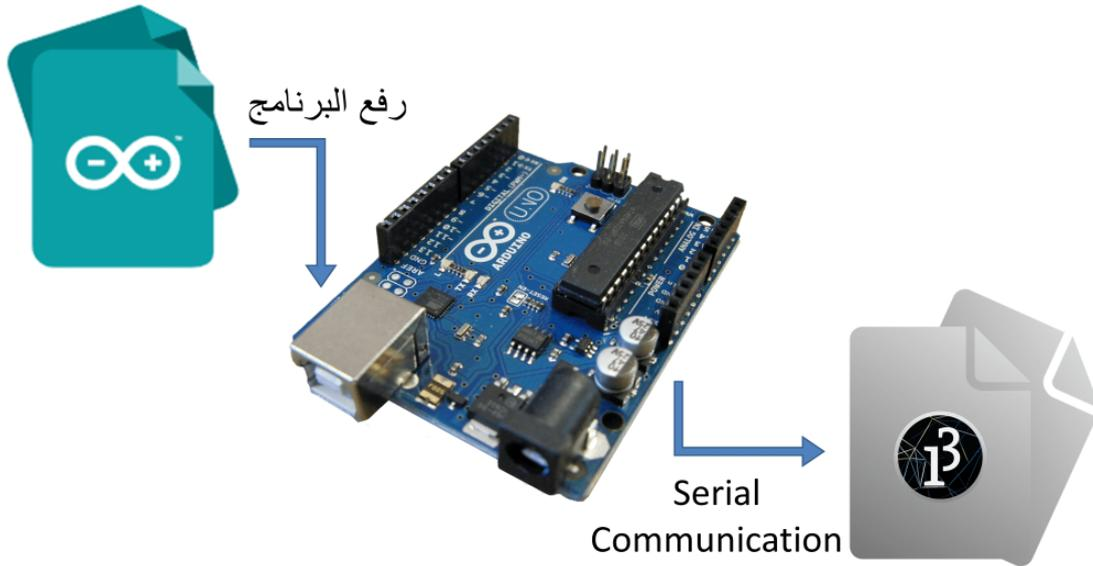
الآن نحن بحاجة لعمل برنامج يتم رفعه على الـ Arduino الذي من شأنه تمكين التفاعل بين Arduino IDE و Processing IDE.
