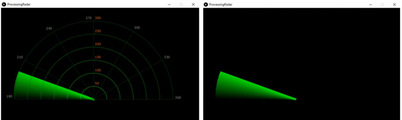
ليتم عمل مسح للرادار يتم رسم الخط الذي يتحرك جنب إلى جنب اتباعا لحركة محرك السيرفو باستخدام الدالة `setupSweep()`. تستخدم الدالة `setupSweep()` الدالة `line()` التي تستخدم المتغير `degree` لإعادة رسم الخط لكل درجة.
