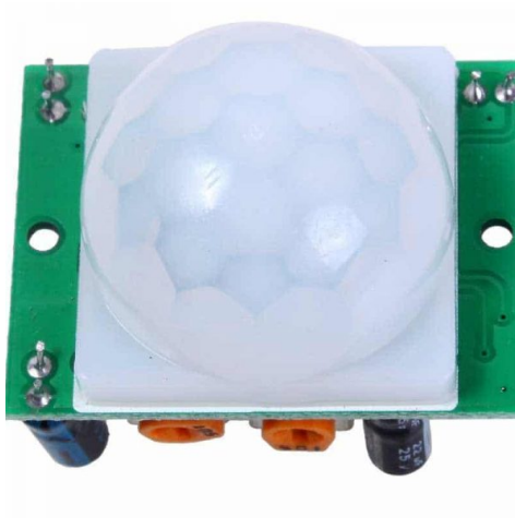
X1 حساس الحركة (pir motion sensor)
