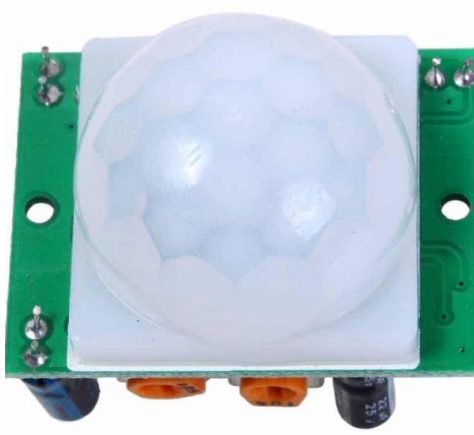
X1 حساس الحركة (pir motion sensor)
