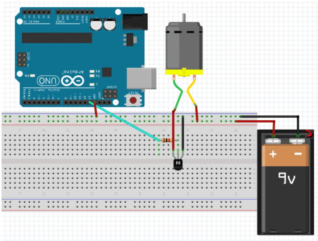
عند توصيل التيار إلى قاعدة الترانزستور بواسطة الأردوينو، يقوم المحرك بالدوران وعند فصل التيار عن القاعدة يتوقف.
