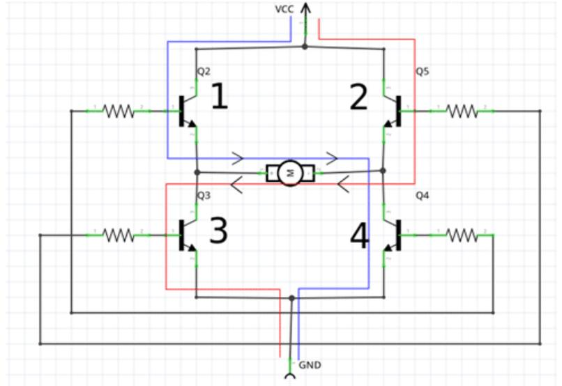
عند تشغيل كلا الترانزستور 1 و 4 يعمل المحرك نحو الإتجاه الأول وعند تشغيل الترانزستور 2 و 3 يعمل المحرك في الإتجاه المعاكس للإتجاه السابق.
