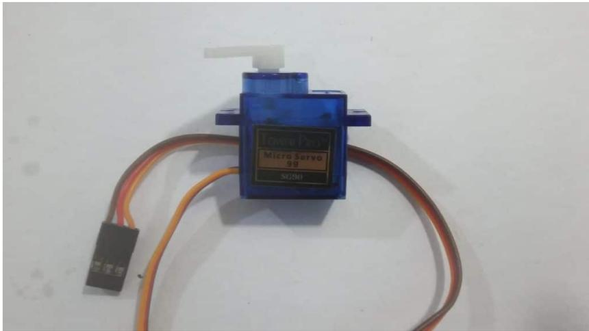
اي عند دخول إشارة كهربائية إلى محرك السيرفو بقيمة معينة ينتج عن ذلك حركة بزواوية معينة ثم يتوقف المحرك عن الحركة ويظل محتفظ بالزاوية التي وصل إليها. على عكس محركات التيار المستمر فإنها تستمر في الدوران بمجرد إمدادها بالتيار الكهربائي.
