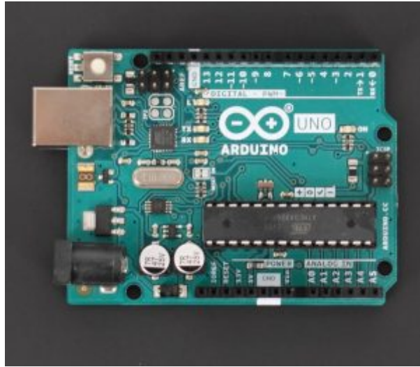
X1 لوحة الاردوينو (Arduino)
