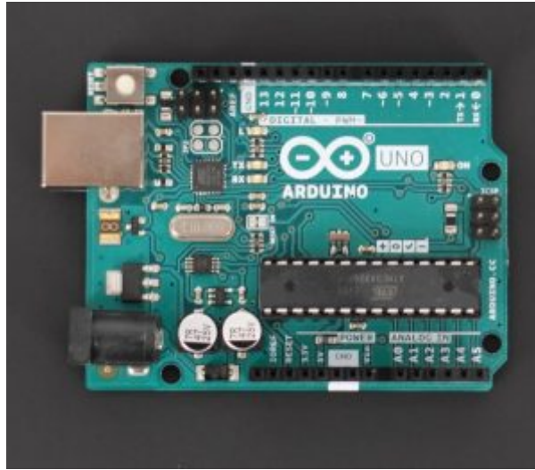
X1 لوحة الاردوينو (Arduino)
