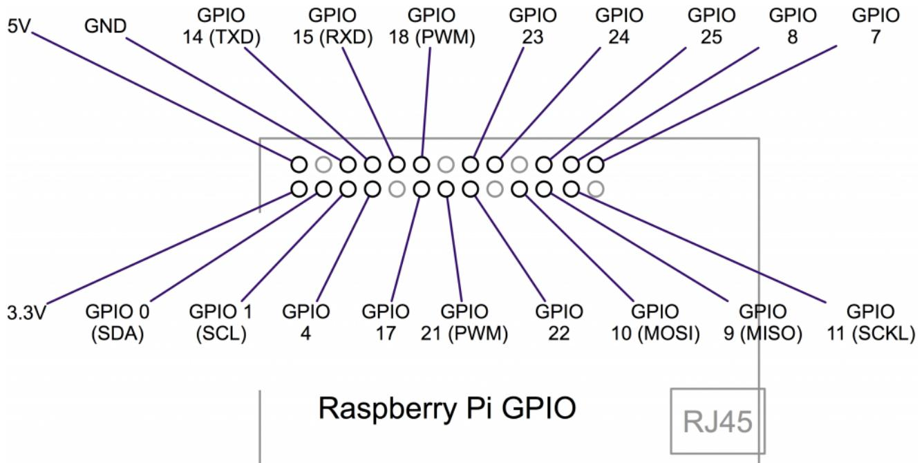
الأرجل (GND 3.3V 5V) خاصة بالطاقة ، وللعلم جميع أرجل GPIO يمكن استخدامها كمدخلات أو مخرجات ، وأيضاً الأرجل SCL و SDA يمكن استخدامها لـ I2C وكذلك الأرجل MOSI و MISO و SCKL يمكن استخدامها لـ SPI.
