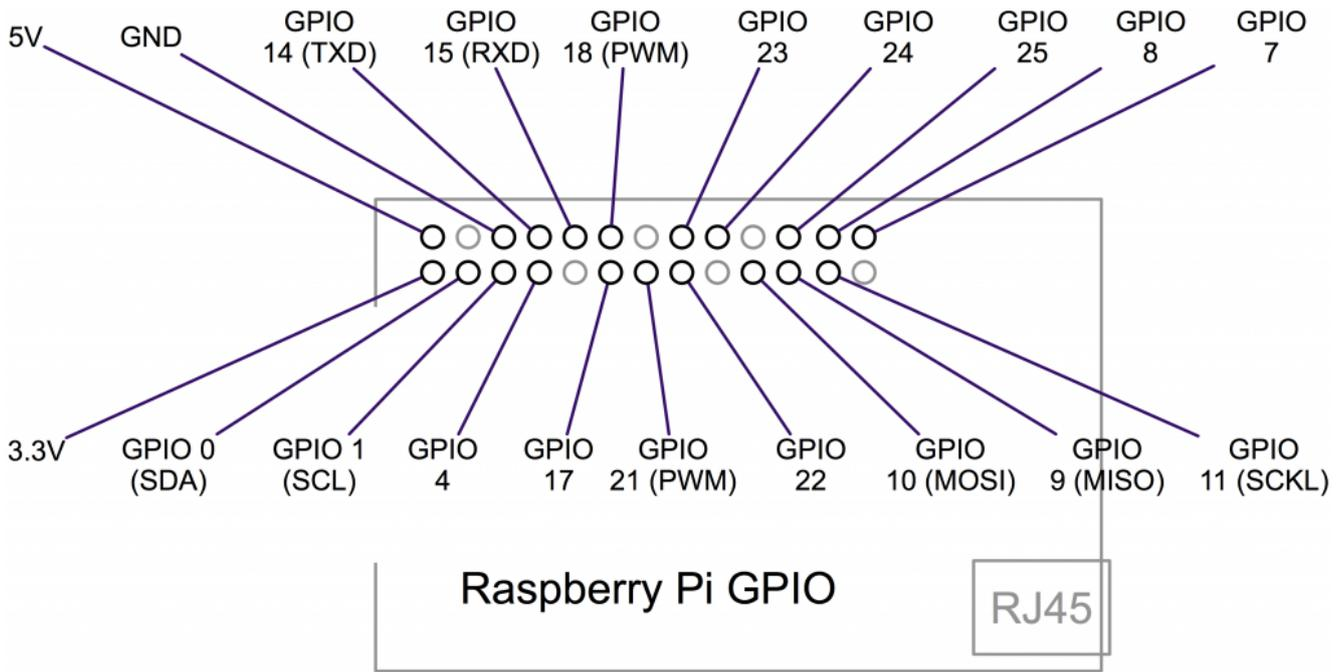
الأرجل (5V 3.3V GND) خاصة بالطاقة ، وللعلم جميع أرجل GPIO يمكن استخدامها كمدخلات أو مخرجات ، وأيضاً الأرجل SCL و SDA يمكن استخدامها لـ I2C وكذلك الأرجل MOSI و MISO و SCKL يمكن استخدامها لـ SPI.
