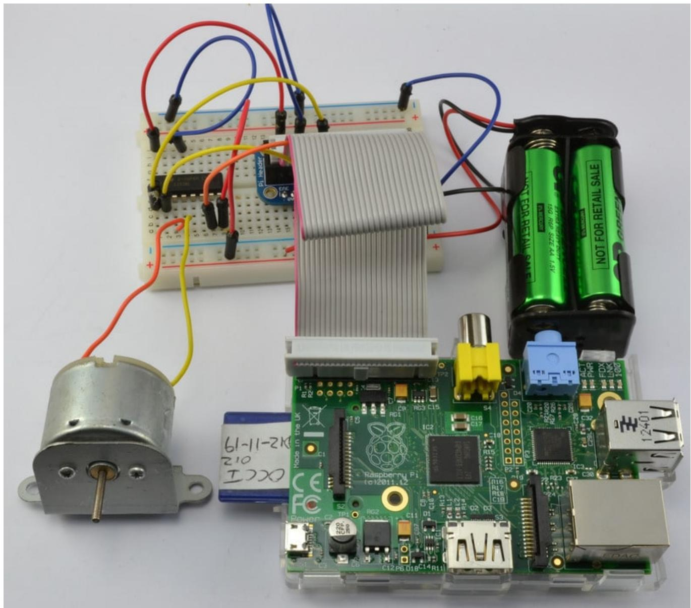
في الدرس الثامن تعلمنا كيف نخرج النبضات من خلال PWM لنجعل محرك السيرفو ، في هذا الدرس سوف نستخدم PWM ولكن للتحكم بسرعة محرك الدي سي ، وسوف نستخدم شريحة L293D للتحكم باتجاه حركة المحرك.
