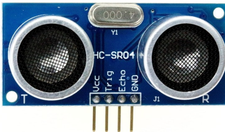
مستشعر الموجات فوق الصوتية (Ultrasonic Sensor HC-SR04)
