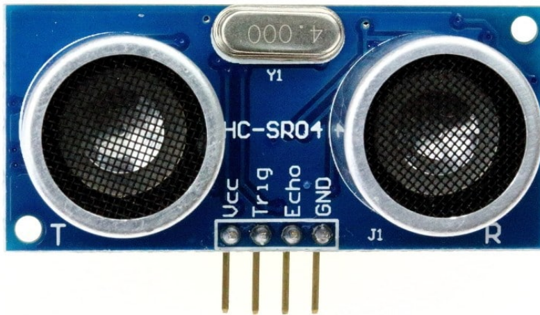
مستشعر الموجات فوق الصوتية (Ultrasonic Sensor HC-SR04)
