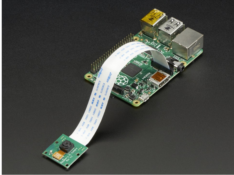
كاميرا للراسبيري باي (raspberry pi camera module) أو USB webcam
