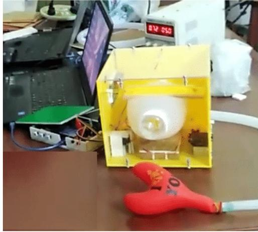
تم تصميمه الشكل الخارجي من مادة بريسبيكس ارخص في التكلفة وتم تشكيلها بواسطة مكنه cnc lezar ومن ثم تجميعها لتصبح على الشكل النهائي ادناه
