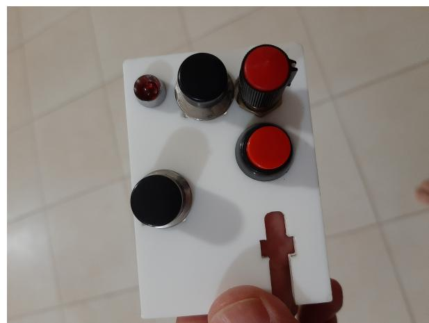
هنا صورة لوحة التحكم يظهر فيها المفاتيح والمقاومة المتغيرة لضبط حجم الهواء الذاهب للمريض: المفاتيح هي كالتالي:
