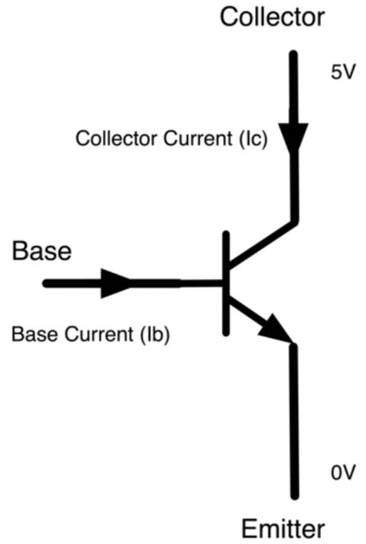
للترانزستور 3 رؤوس . معظم التيار الكهربائي يذهب من 'collector' إلى 'Emitter'، ولكن هذا يحدث فقط إذا تم تمرير تيار قليل عبر 'Base connection'. هذا التيار القليل يتم توفيره من الازدوينو.
