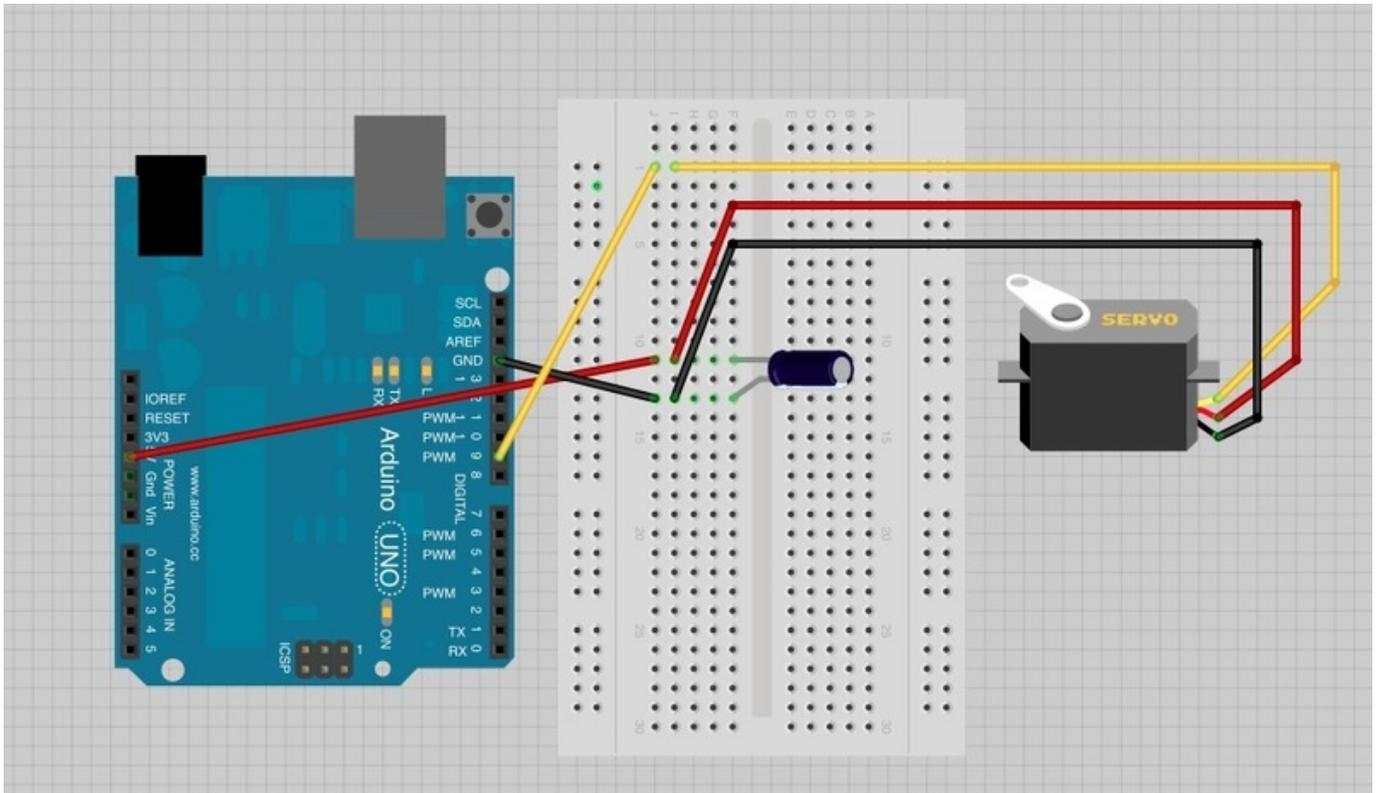
المكثف 'capacitor' يعمل كخزان للتيار الكهربائي حيث يسمح للمحرك عند بدء تشغيله بأخذ التيار المخزن بالمكثف اضافة للتيار الذي يقوم بأخذه من الأردوينو.
