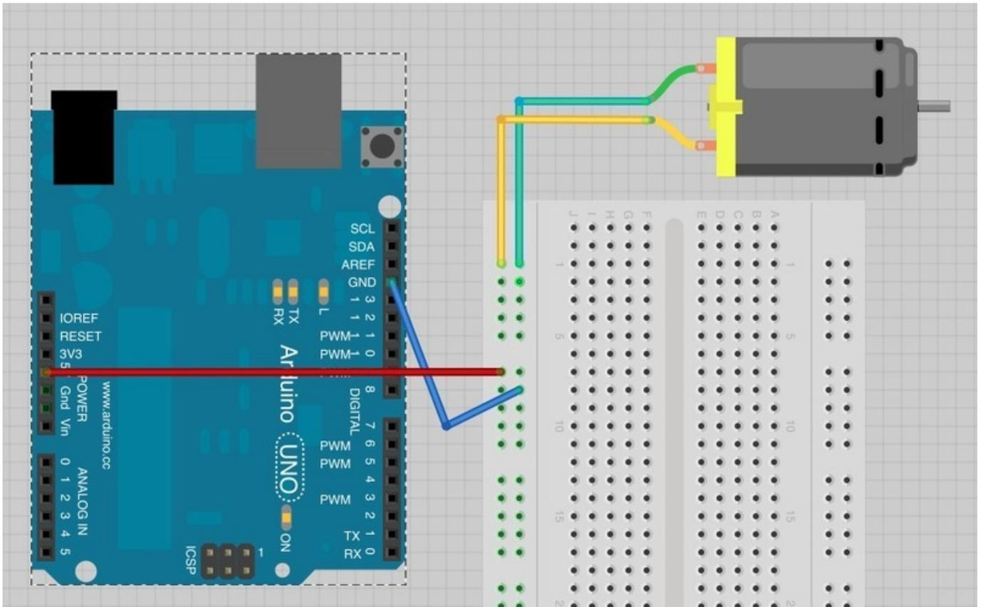
لاحظ اتجاه دوران محرك DC Motor، يمكنك لمس محرك DC Motor بأصابعك لمعرفة اتجاه الحركة . يمكنك عكس اتجاه حركة محرك DC Motor عبر عكس توصيلات المحرك (قم بتبديل توصيلة ال-5V بـGND ، كذلك الحال مع التوصيله الأخرى) بذلك سترى انعكاس لاتجاه حركة الدوران.
