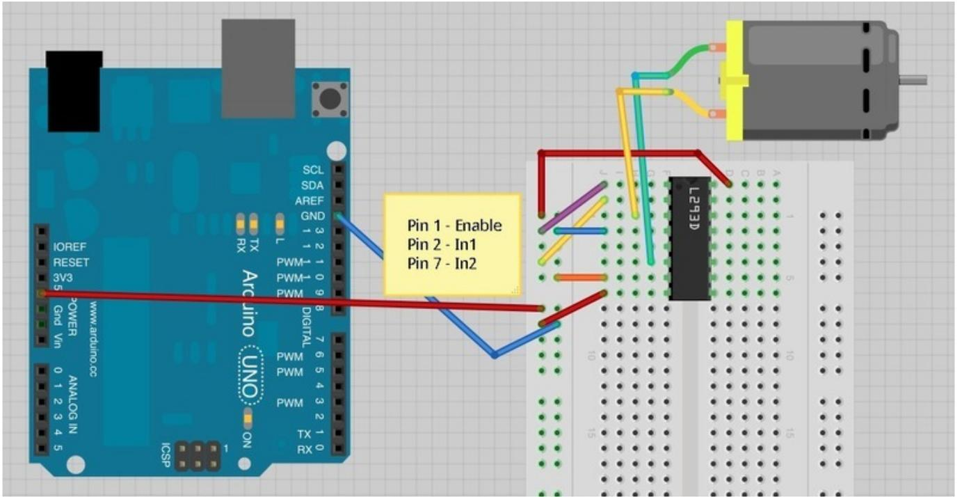
المنافذ التي تهمننا بالنسبة لرقاقة التحكم بالمحرك L293D هي ثلاث منافذ ، منفذ 1 (Enable Pin 1)، منفذ 2 (In1 Pin 2) ، ومنفذ 7 (In2 Pin 7) .
