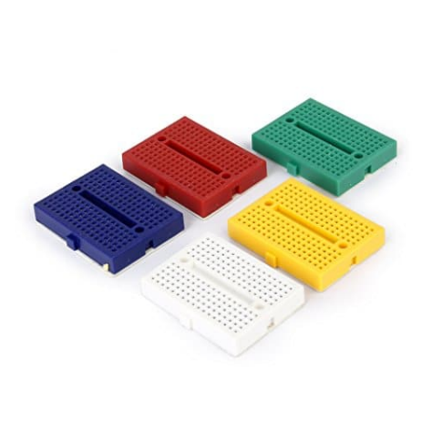
X1 لوح تجارب صغير (small size breadboard)
