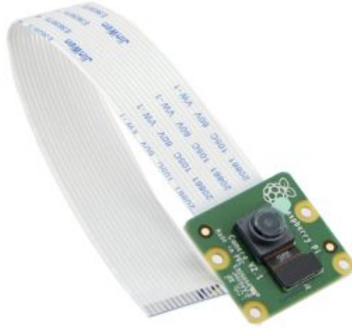
×1 كاميرا للراسبيري باي (raspberry pi camera module) أو USB webcam
