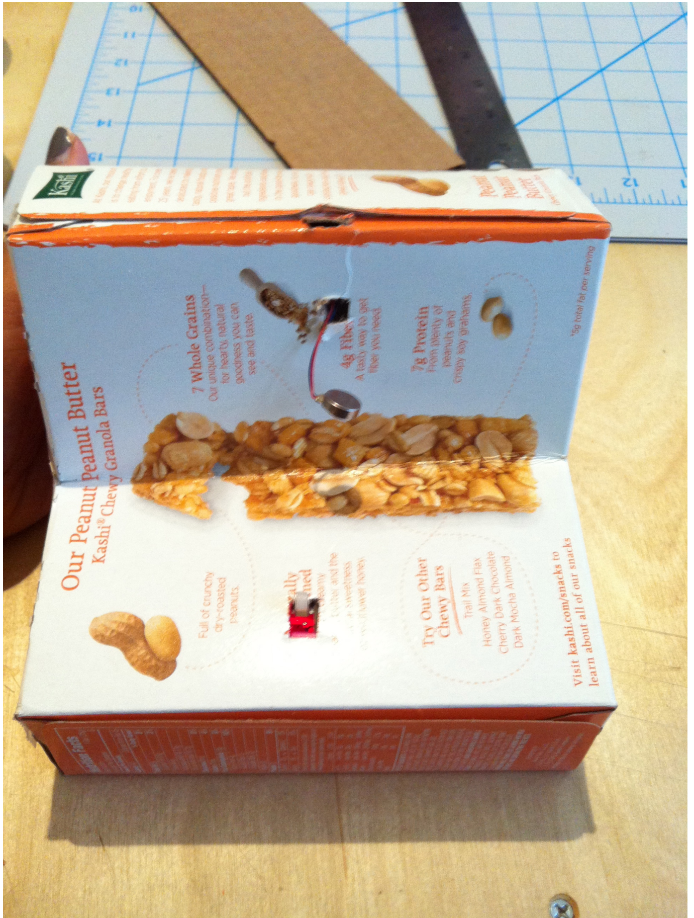
سنقوم بصنع فتحة صغيرة في الجزء العلوي من الكرتون ونخرج محرك الاهتزاز لتحريك اللسان
