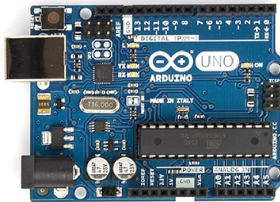
لوحة الأردوينو (Arduino Uno)
