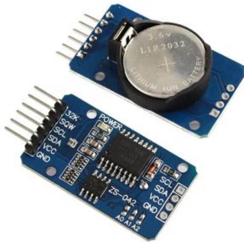
مؤقت ساعة حقيقي - RTC Real Time Colck
