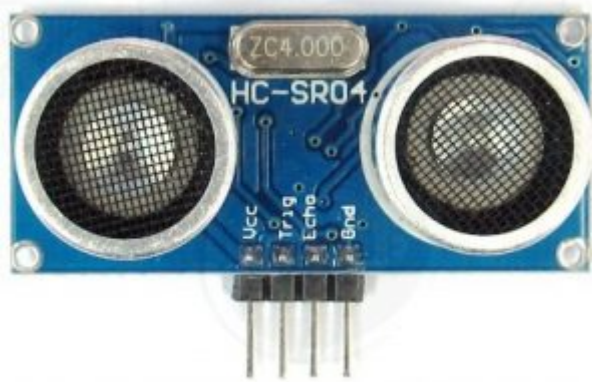
Ultrasonic Module حساس تحديد المسافات
