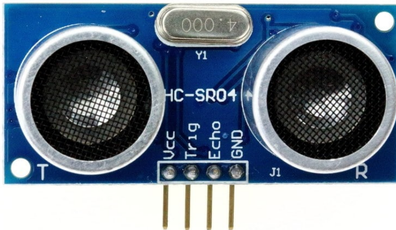
مستشعر الموجات فوق الصوتية (Ultrasonic Sensor HC-SR04)
